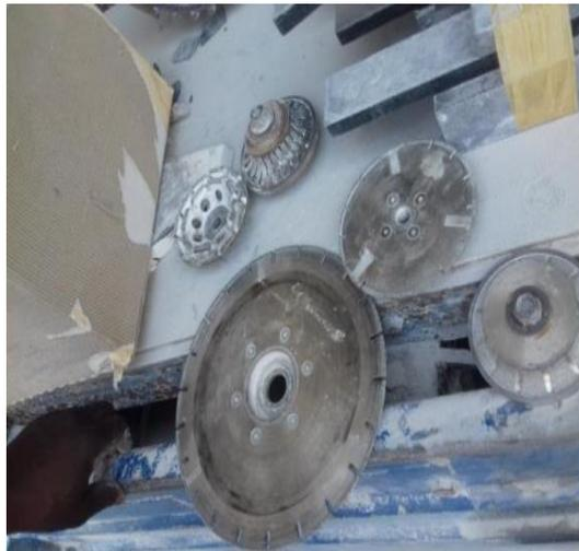
**Figura 3.18: Discos para acabamento (para granito em cima e para mármore embaixo)-(Fonte: O autor).**
