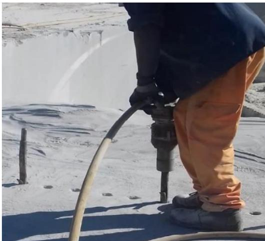
**Figura 3.11: Criação de pressão com o martelo pneumático (Fonte: O autor)**
