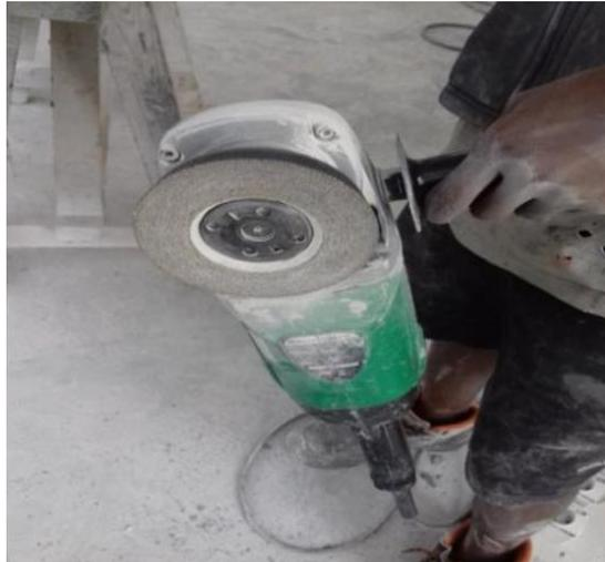
**Figura 3.17: Máquina de polimento manual (Fonte: O autor)**
