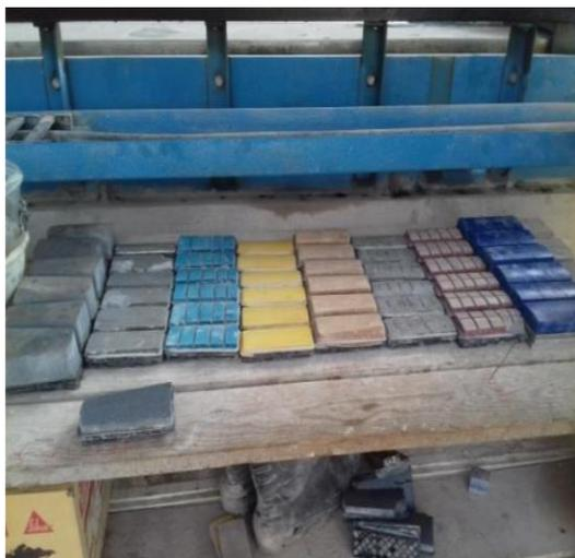
**Figura 3.16:** Calços usados para o polimento de granito (Fonte: O autor)
