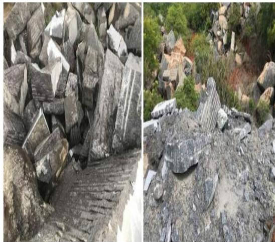
Figura4.8: Descarte de Blocos rejeitados (Fonte: O autor)
